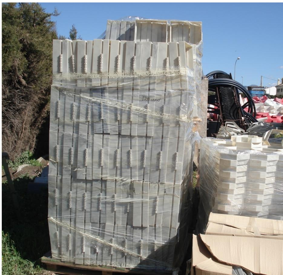
Imagen 10. Palé de juntas de inyección.
