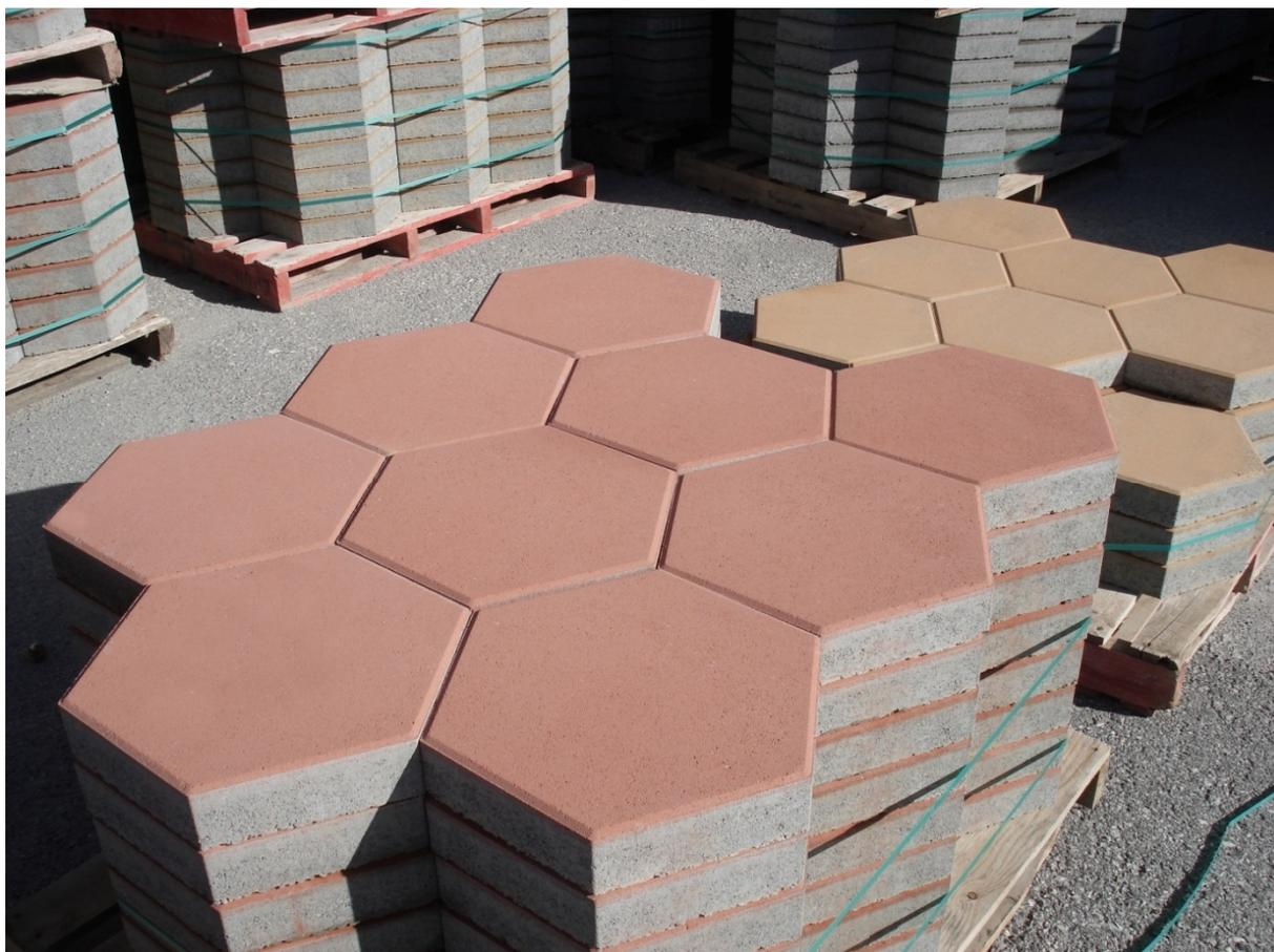
Imagen 9. Palé de piezas prefabricadas.
