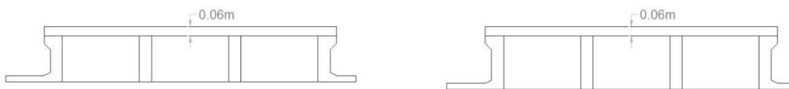
**Image 50.** Sections Hourdis de 30 et 35 cm avec dalle de compression exécutée pendant préfabrication.
