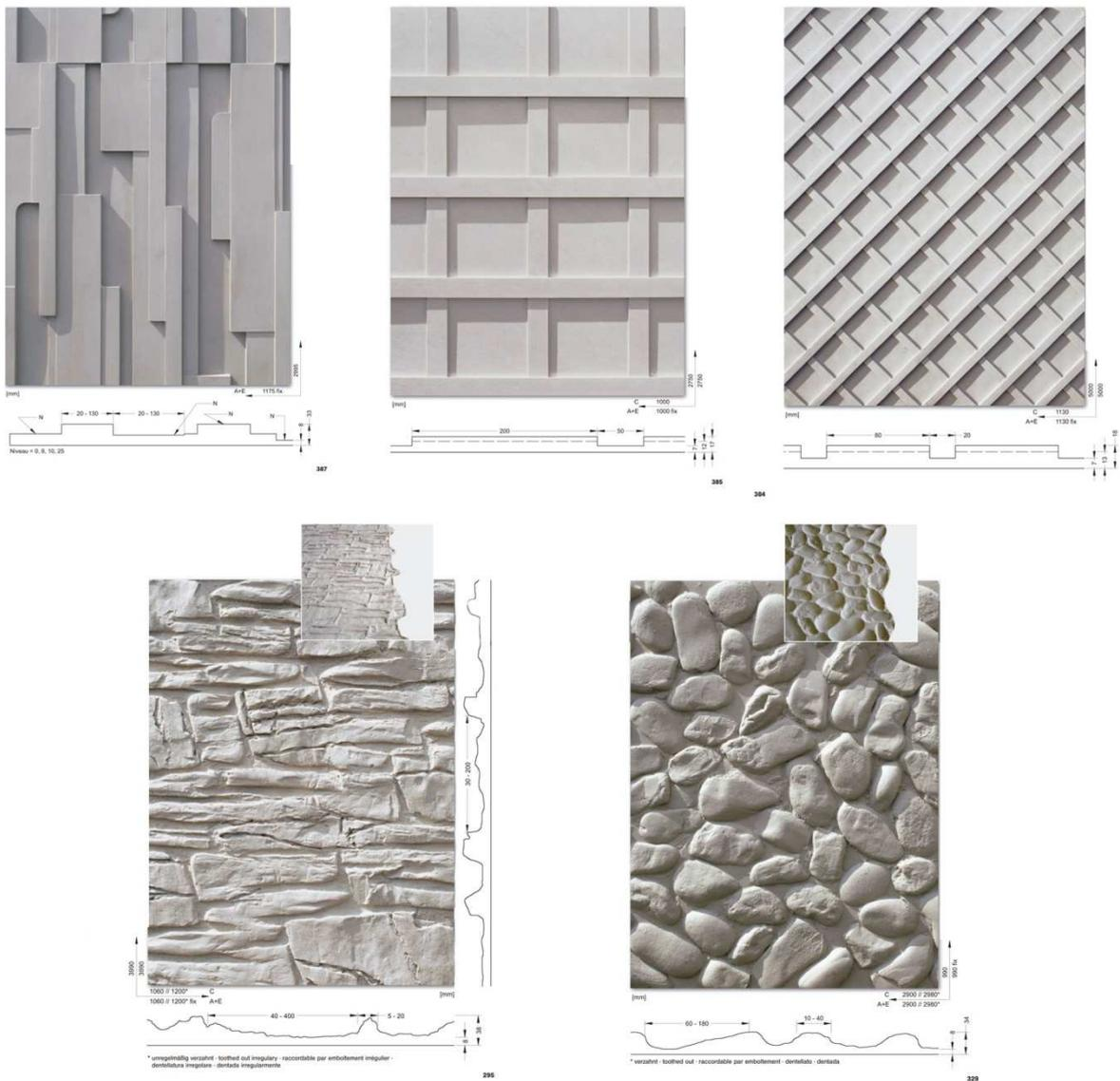
**Image 63.** Solutions constructives pour finitions de la face antérieure.
