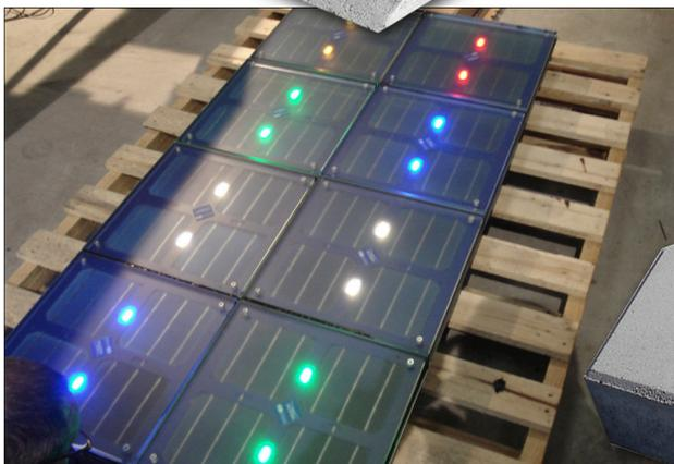
Además nuestra baldosa de 40 x 40 cm permite convertir al pavimento en un elemento activamente energético, siendo una solución válida para alumbrado público, servicio doméstico o conexión a red.
